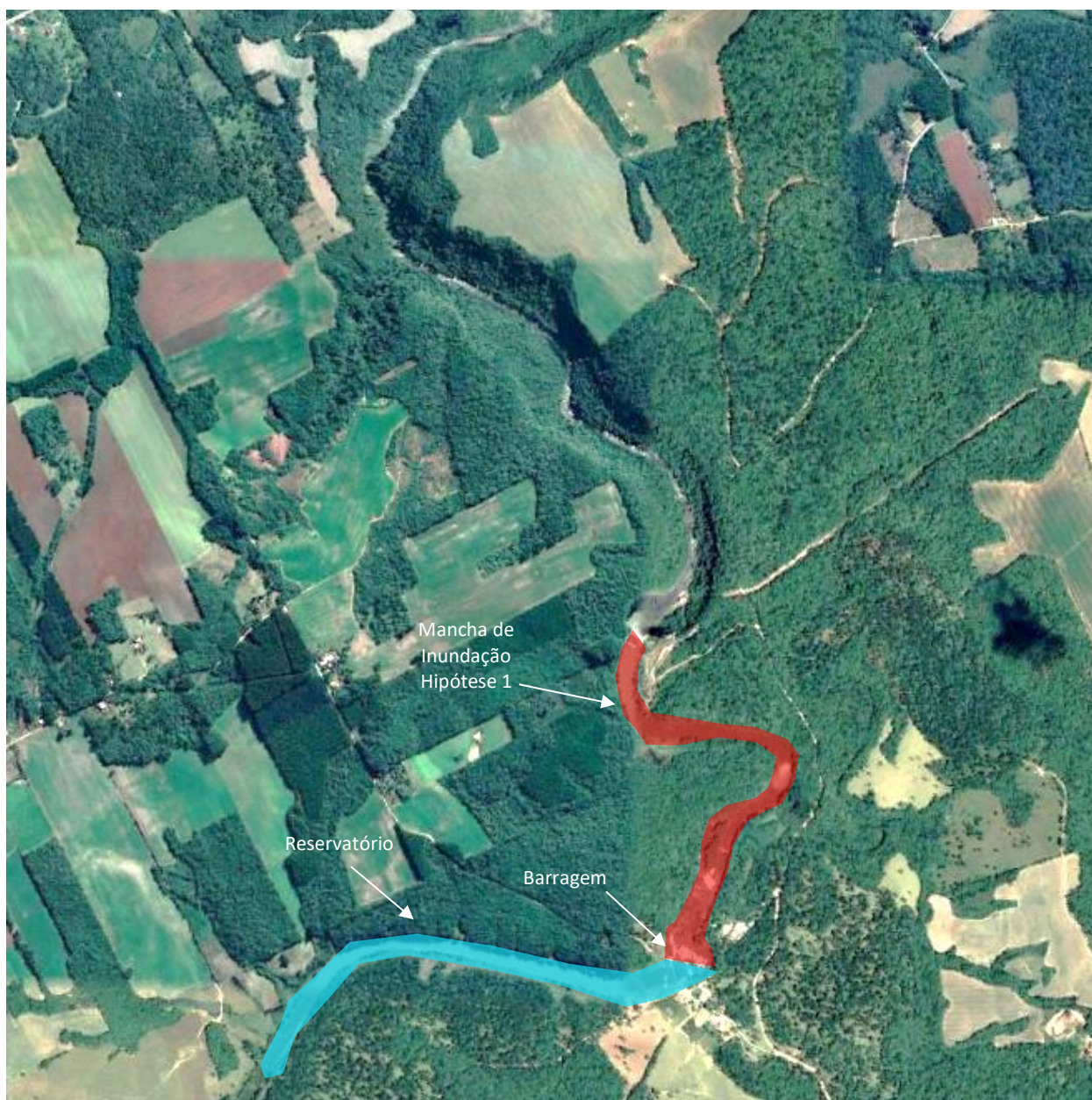
Figura 14. Mancha de Inundação à Jusante da PCH Dois Saltos – Hipótese 1
