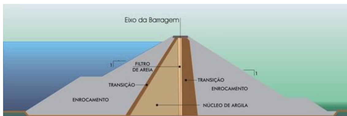
Figura 10. Corte típico de barragens de hidrelétricas
